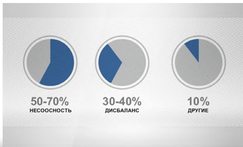
Рис 4.3 Основные источники вибрации машинного оборудования
