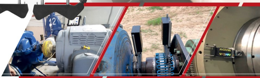
Рис.3.8 Лазерная система VIBRO-LASER использует 2 лазера и 2 приемника
