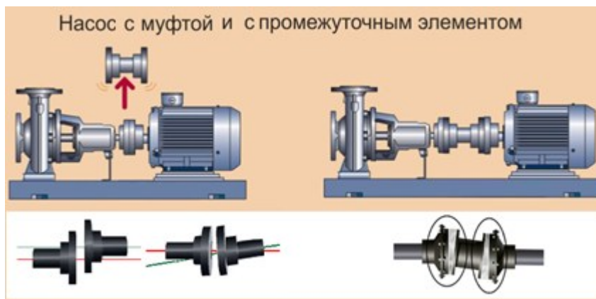
Рис. 1.16 Агрегат с муфтовым соединением и с промежуточным валом
