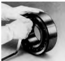
Рис. 1. Проверка зазора подшипника на верстаке.
